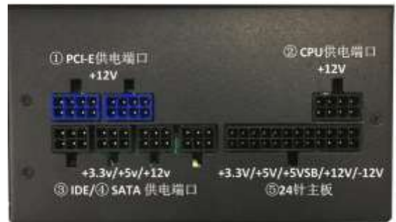
图 11 开关电源端口
